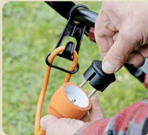
La boucle de raccordement est sécurisée!
