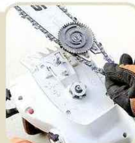
Dépose pour maintenance de la chaîne et son guide.
