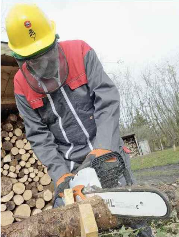
Tenez toujours votre tronçonneuse à deux mains !
